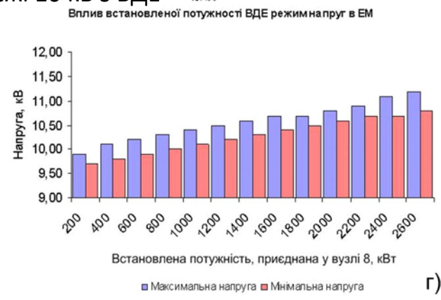
Рисунок 2 – Залежності втрат електроенергії і значення напруги від потужності джерела енергії у вузлі 8
