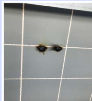
Рис. 4 - Зростання опору та нагрів контактів в місці з'єднання sells busbar ФЕМ
