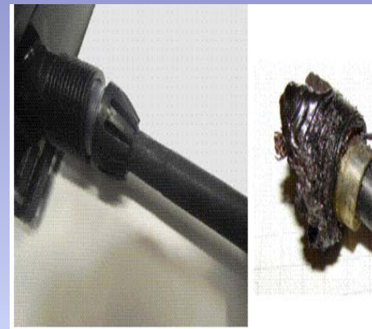
Рис. 1 - Клемний термінал junctionbox – місце можливого перегріву
