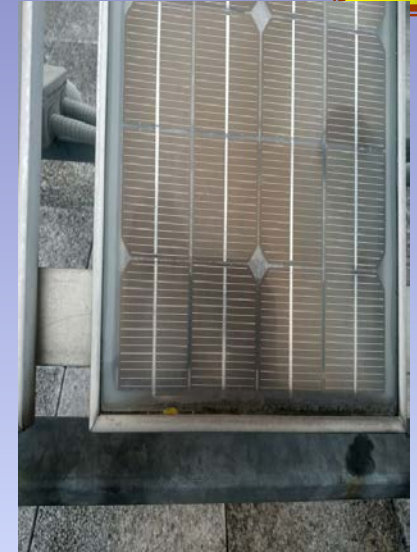
Рис. 2 - Пошкодження герметика ФЕМ та склопакету
