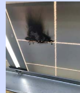
Рис. 5 - Зростання опору та нагрів контактів в місці з'єднання sells між собою або пошкодження діоду Шоттки
