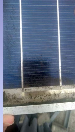
Рис. 2 - Пошкодження герметика ФЕМ та склопакету
