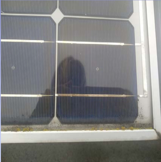
Рис. 1 - Пошкодження каркасу ФЕМ (пошкодження герметика, пошкодження рамки, пошкодження кріплення)
